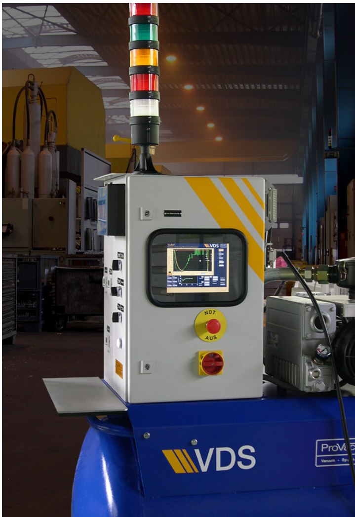
Bild 1 : Die ProVac® PLC-250 Steuerung mit dem VAMP an der rechten Türe
